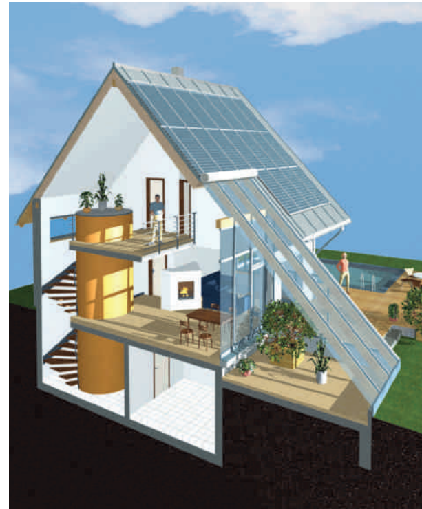
Das Grundkonzept für neu gebaute Sonnenhäuser wurde auch bei diesem Altbau angewendet: große und steile Solarthermieflächen, ein großer Wärmespeicher und ein Holzofen als Zusatzheizung.
