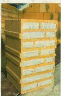
Diese Ziegel sind aufgebaut wie eine Praline. Außen harter Stein, die Füllung ist eine weiche Masse aus Mineralgranulat. Der Stein macht extra Dämmplatten überflüssig.
