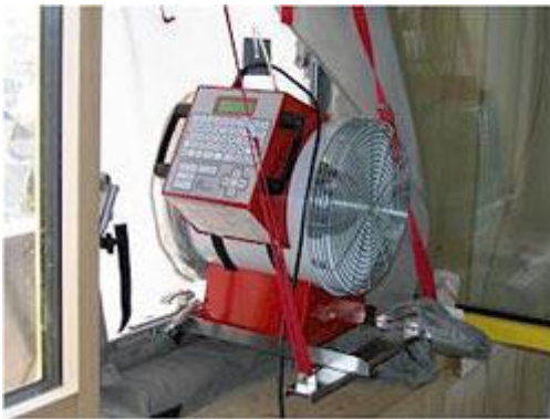
Mit dem "Blower Door-Test (links) wird Luftwechselrate getestet. Extra dicke Wände und spezielle Fenster sorgen für optimale Wärmedämmung.
