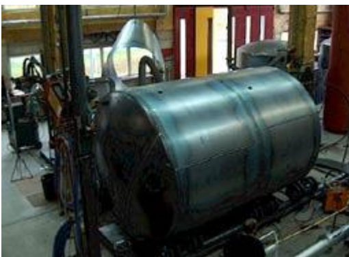
Speicherfertigung bei der Jenni AG; montierter Solarspeicher.
